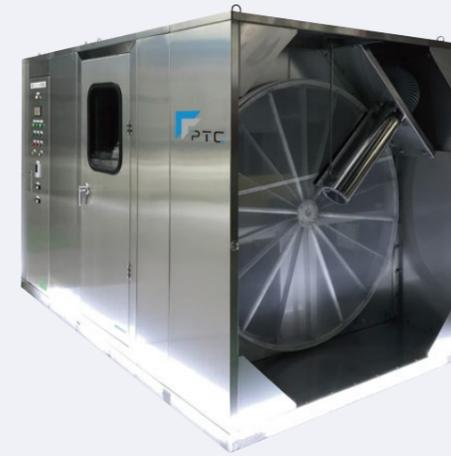
弊社のシステムは一般的な給気装置ではなくエアバランスに特化した空調設備です。1次フィルターでは自動洗浄能力を持ち、2次フィルターでは任意でプレ+高性能Fを搭載しております。更に、お客様の要望に合わせて冷温水コイルや、蒸気ヒーターを搭載し、外気処理空調システムとして設計・ご提案させていただきます。
